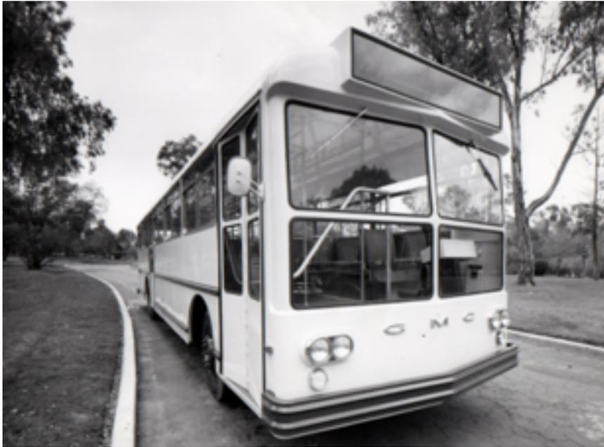
Diseño de camión con carrocería de una sola pieza y amplios ventanales.
